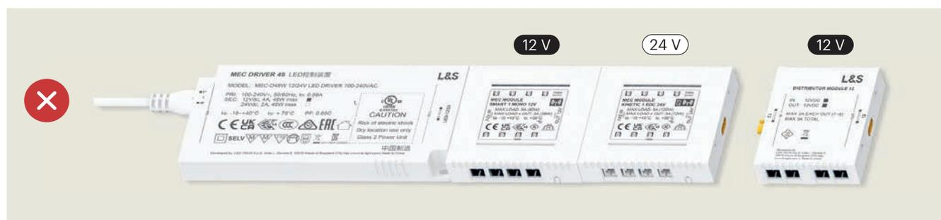
**✗ ERRATO COLLEGAMENTO:** Moduli con tensioni di esercizioni miste/differenti
