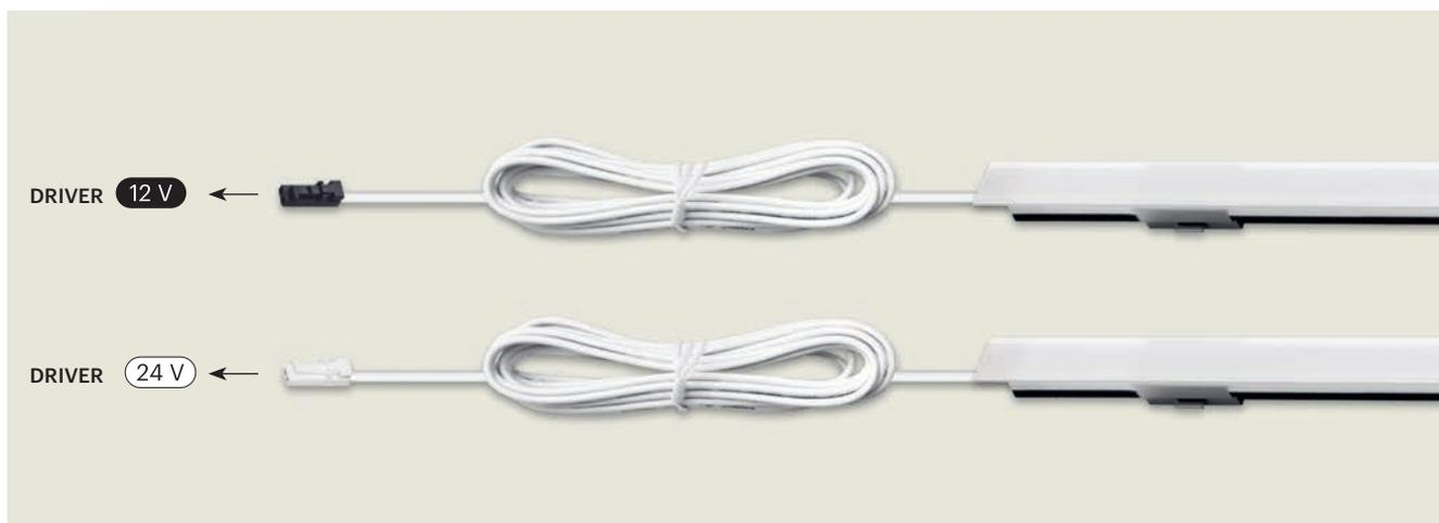
Ogni apparecchio di illuminazione è dotato di cavo di alimentazione completo di connettore montato all'estremità; il colore del connettore di alimentazione identifica chiaramente la tensione di alimentazione dell'apparecchio di illuminazione: Nero **12 V** / Bianco **24 V**; il colore ricalca quello delle vie/uscite presenti nei Moduli di Distribuzione o di Controllo ai quali collegare gli apparecchi di illuminazione (§ 5.4)
